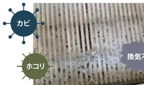
ダクト式の熱交換換気の熱交換素子の多くは薄型紙（和紙）の層築で作られています。このような素材の素子は耐久性が低く、水洗いを行うことが出来ません。そのため、ホコリが溜まって目詰まりを起こしたり、水分や汚れによる劣化も早く定期的に交換のコストがかかってしまいます。
